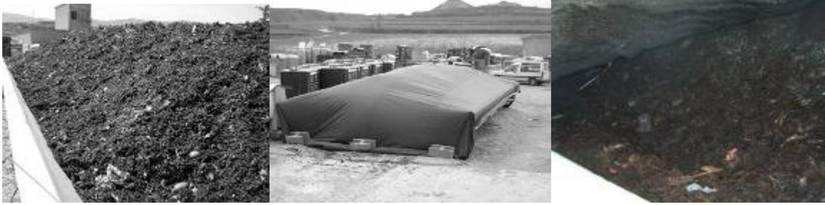
Fig. 5, 6 y 7 Sistema de compostaje utilizado en la prueba piloto lleno; vista general del sistema de compostaje utilizado en la prueba piloto lleno y con la cubierta textil colocada; aspecto del material (bajo cubierta) después de unas semanas de compostaje. (Martín & Giró, 2008)
