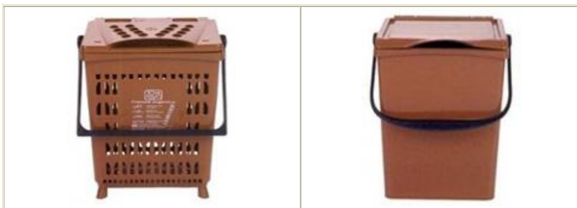
Imagen 6.4. Cubo aireado (izquierda) y no aireado (derecha) utilizados en los ensayos.
