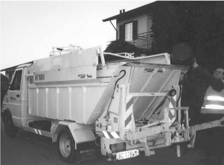
Imatge 4.6. Camió de caixa oberta per a la recollida selectiva de la matèria orgànica. Vista de detall.
